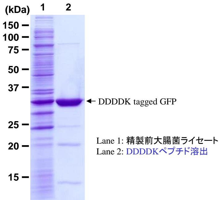
DDDDK tagged GFP プラスミド DNA で形質転換した大腸菌 BL21(DE3)RIL を 1 mL LB 培地で 27°C、12 時間培養しました。大腸菌ペレットを細胞溶解バッファー 0.5 mL に溶解させ、プロトコールに記載した方法で精製しました。
